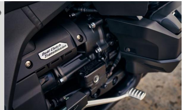
Le positionnement de la transmission sous le vilebrequin, en rotation opposée à celui-ci, permet de neutraliser les réactions de couple moteur. L'intégration du démarreur et de l'alternateur en une seule unité contribue à alléger le moteur de plus de 5,9 kg par rapport à l'ancienne version !
