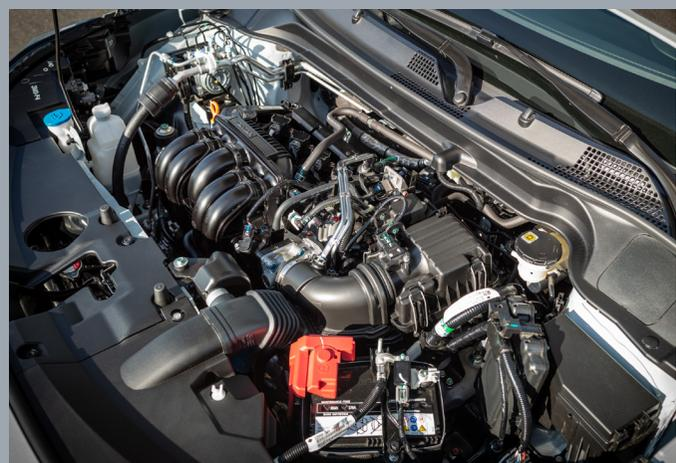
Moteur DOHC i-VTEC 1,5 L avec Transmission à Variation Continue (CVT)
